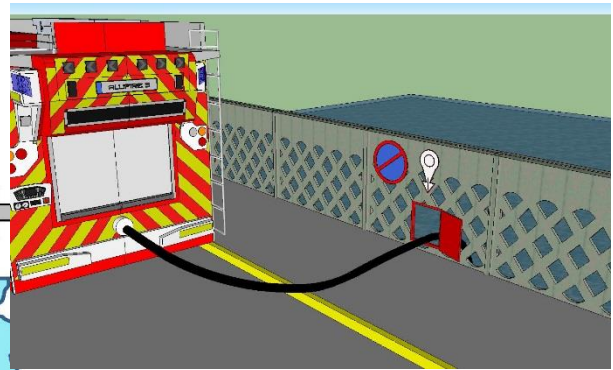
Illustration n°3 : trappe d'accès depuis un pont
