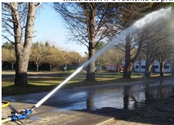
Illustration n°2 : exemple d'une lance canon
