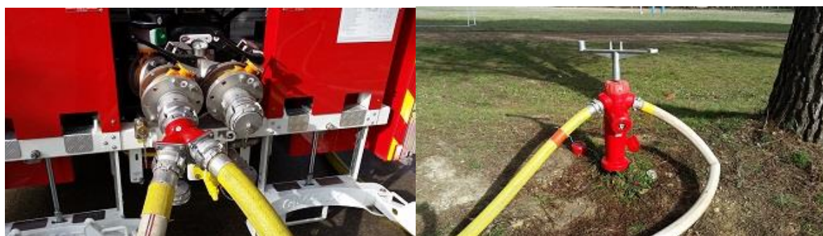
Illustration n°2 : alimentation d'un engin pompe à l'aide de deux lignes de 70 (et d'un collecteur) (Crédit photo @ ENSOSP)
