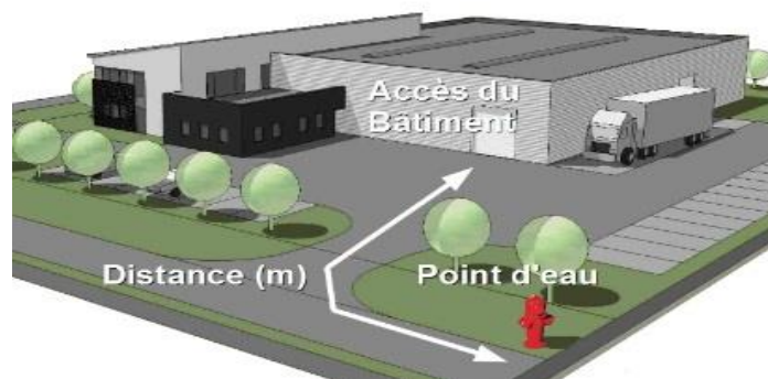
Illustration n°1 : schéma de principe de positionnement d'un point d'eau
