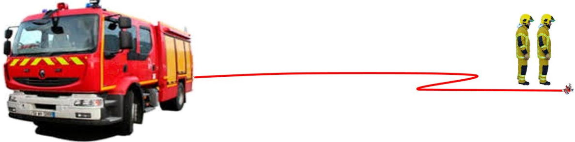
Illustration n°1 : schéma de principe de l'établissement d'une division d'alimentation (dévidoir mobile, tuyaux en couronne ou en écheveaux)
