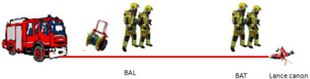
Illustration n°1 : Schéma de principe d'établissement d'une lance canon
