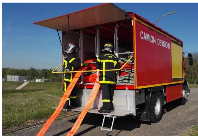
Illustration n°8 : Utilisation d'un dévidoir automobile (Crédit photo @ SDIS 38)
