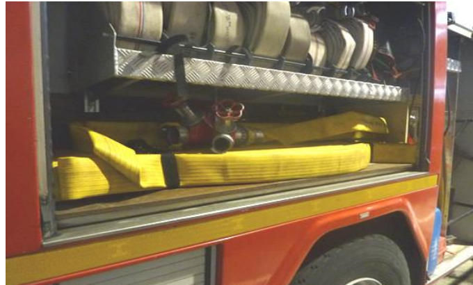
Division pré connectée sur tuyau en écheveau
