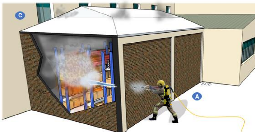
Illustration n°2 : utilisation d'une lance autoforante
