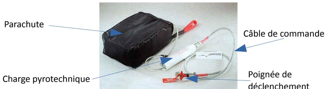
Le principal risque est la mise à feu de la charge en cas d'incendie ou d'action sur le câble de commande (découpe, tirage, etc.) donnant lieu à l'éjection du parachute.
