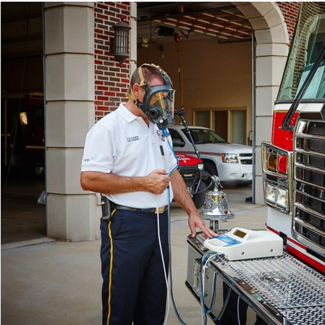
Figure 7 : Fit test quantitatif par méthode de pression (site fabricant OHD)
