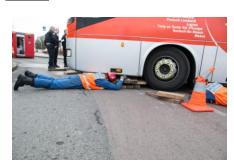
**2.** Les suspensions sont <u>neutralisées</u> à l'aide de bastaings et de sangles à cliquets, pour rigidifier l'ensemble châssis-suspensions et éviter le débattement de ce dernier lors des opérations de levage
