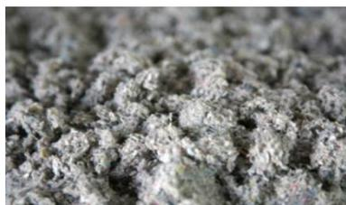
La ouate de cellulose est un isolant fabriquée à partir de journaux recyclés (85 % environ) et d'additif (15 %) comme le sel de bore (ignifugeant).
