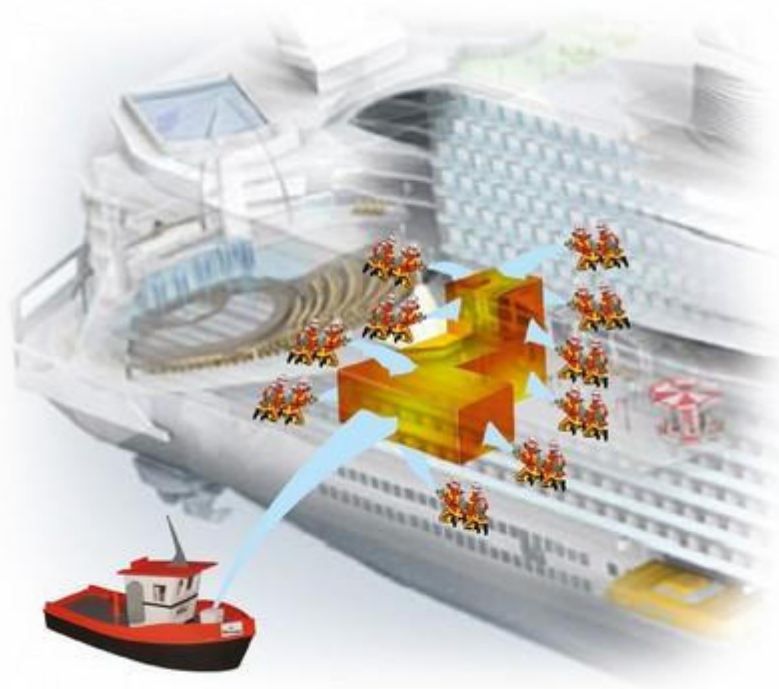
Cas de la définition du « cube » intégrant plusieurs locaux sur plusieurs ponts.
