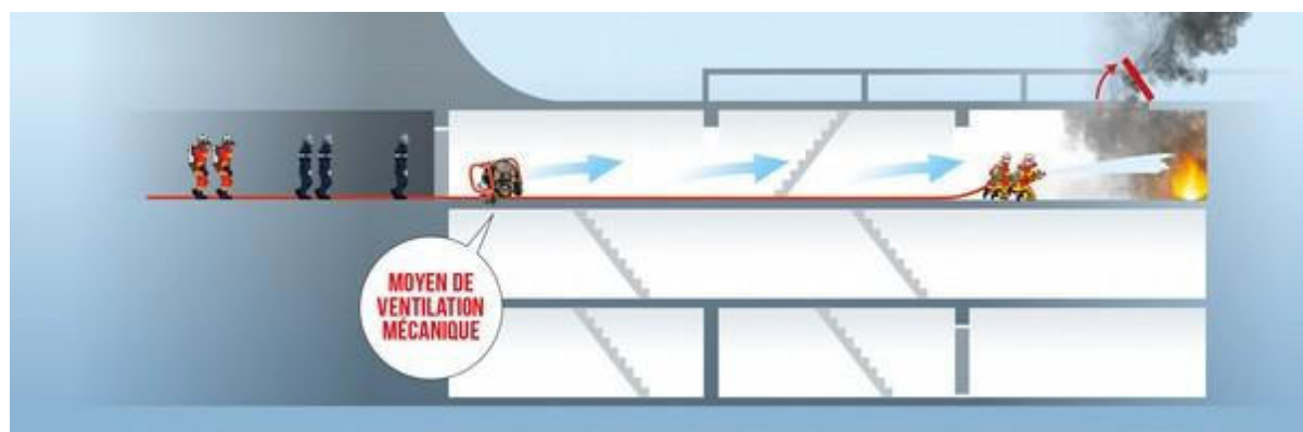
Mise en œuvre du désenfumage dans un local disposant d'un exutoire donnant directement sur l'extérieur.
