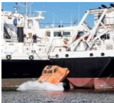
Embarcation de sauvetage à mise à l'eau en chute libre « Free fall »
