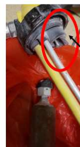
Cassure du support de fixation de la sparklet
