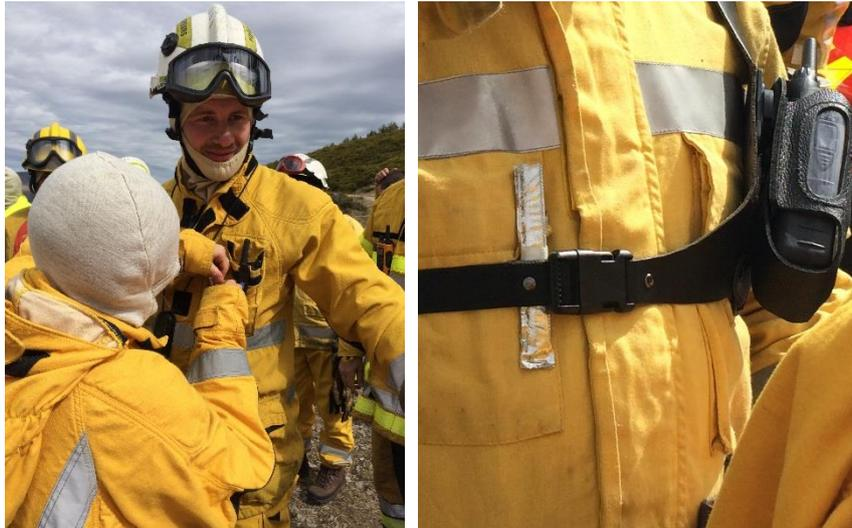
Fig.54 : Fixation des tubes passifs pour le dosage du CO et du Formaldéhyde
