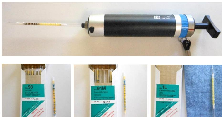
**Fig.10 : Pompe de prélèvements et tubes colorimétriques GAZDETECT**
