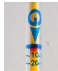
Ces prélèvements (Tenax et tubes colorimétriques) sont réalisés dans des conditions d'enfumage important, pour évaluer les niveaux de toxicité des produits dosés.
