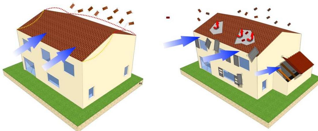
*C'est l'accélération du vent à la surface des pans de toiture qui conduit à une différence de pression entre la surface extérieure et le comble d'où l'arrachement de la toiture par le haut.*
