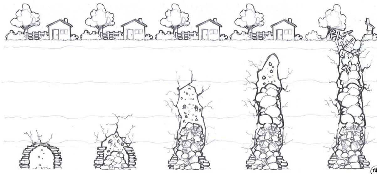
Exemple de fontis causé par la dégradation progressive de la voûte d'une galerie de mine
