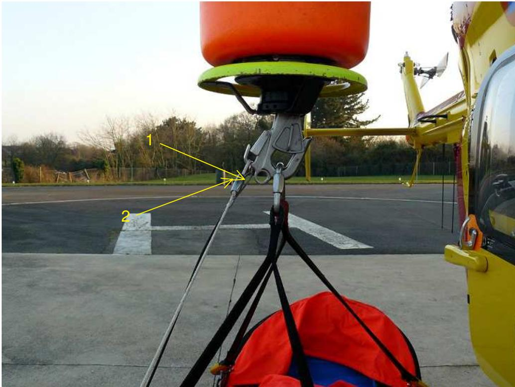
Le câble anti-statique (rep n° 1) est positionné dans le crochet secondaire.
