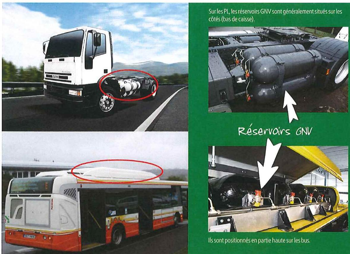
Exemples de positionnement des réservoirs GNV. GNC ci-dessus et GNL ci dessous
