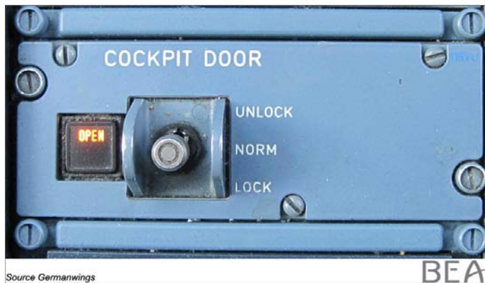
Figure 5 - interrupteur de contrôle de la porte
