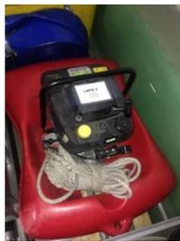
Les LASS sont inefficaces pour assécher les appartements (jusqu'à 10 cm d'eau) car l'eau additivée mousse dans la cuve des aspirateurs et déclenche la jauge de niveau max. L'eau est évacuée à l'aide d'écopos.
