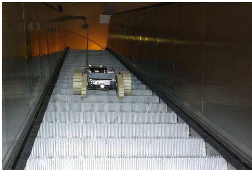
FIG. 16: Descente Escalier mécanique
