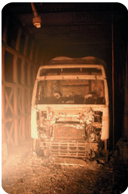
Véhicule type poids lourd détruit par les flammes dans le tunnel. Source : SDIS 62
